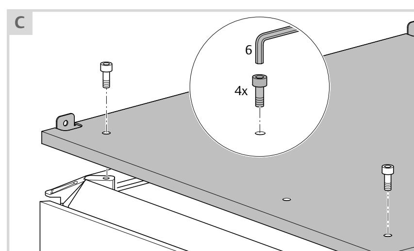
Monter l'adaptateur et l'équerre de fixation
