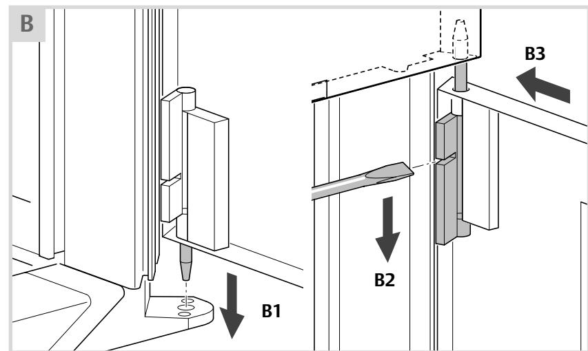
Adapter und Befestigungswinkel montieren
